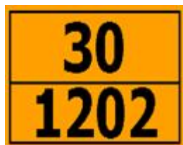
Pannello dei codici di pericolo
